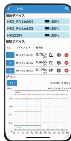
圧力計への設置、計測イメージ。Bluetooth により、10m 程度離れていても計測可能
