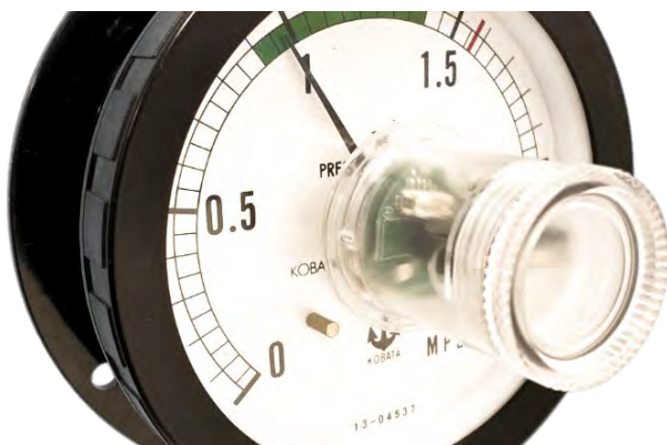
図表 3-2-5 後付けセンサーユニット salta を機械式メーターに設置した状態
