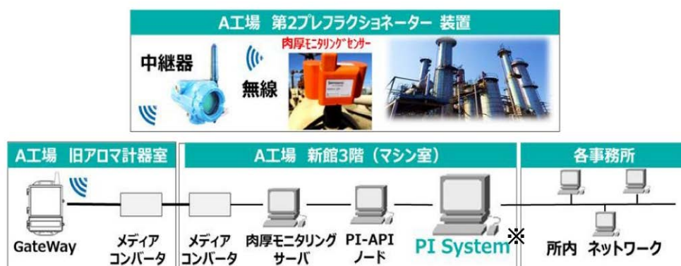
図 2-20 肉厚モニタリング技術のシステム構成
