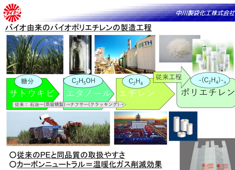
図 3-35 バイオマスレジ袋の製造工程
