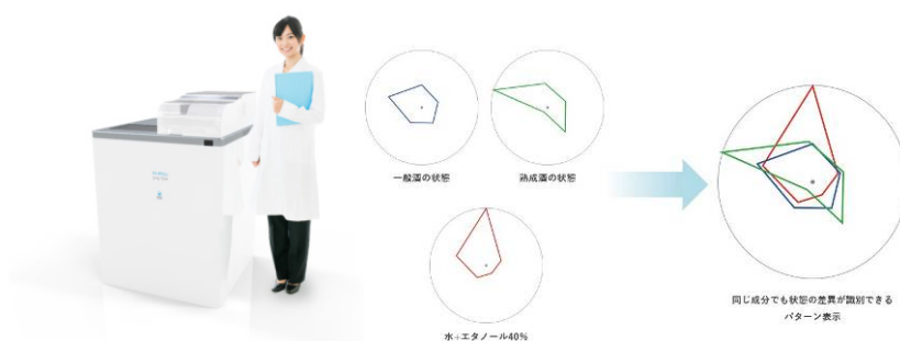
図 3-37 テラヘルツ波測定装置（左）とレーダーチャートの一例（右）
