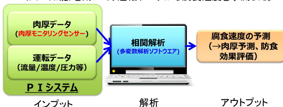
図 2-21 予測分析ソフトウェアによる腐食予測概念図
