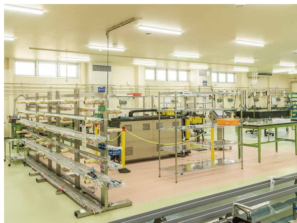
製造用クリーンルーム (加工・溶接・気密耐圧試験・梱包) クラス6(粒子上限濃度:1000個/cf)
