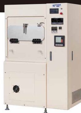
500x500 テストプレス装置 KVHCII
