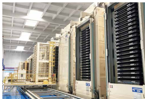
銅張積層板(CCL)成形用20段真空プレス
