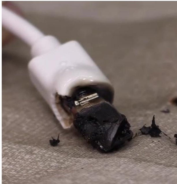
図5 焼損した充電ケーブルのコネクターのイメージ(提供:NITE)
