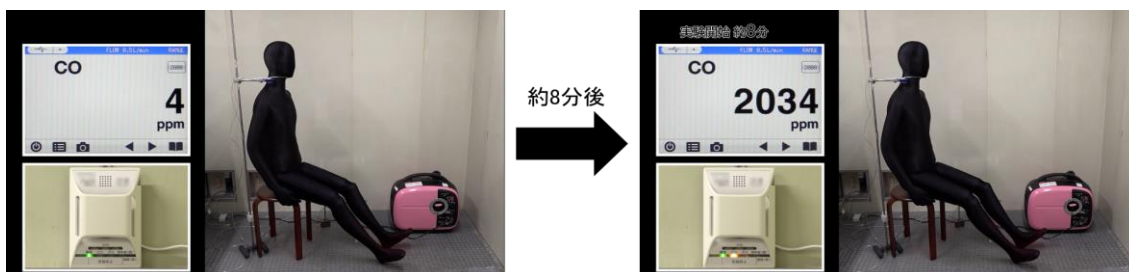
図 2 室内で携帯発電機を使用した際の一酸化炭素中毒(提供:NITE)
