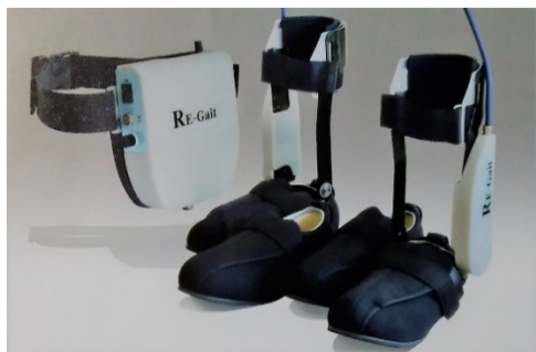
(写真2)RE-Gaitの写真 (左の機材を腰に巻き、右の2つを両足首に取り付けて関節部に力を適宜加える) [株スペース・バイオ・ラボラトリーズの提供]
