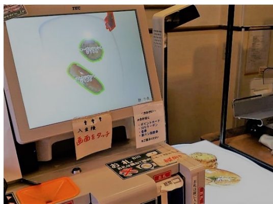
(写真1)パンの種類を読み取り、価格を表示するレジ(パンを右のトレーに置くと、上のカメラが種類を瞬時に識別して、支払額をパネルに表示する。下の自動支払機に現金投入で終了。)[筆者撮影]
