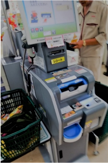
(写真3)顧客が自分で現金を投入する新型機 (レジ係が計算した支払総額を見て 客が現金を投入すると、商品の詳細 リストと釣銭が出てくる。) [著者撮影]
