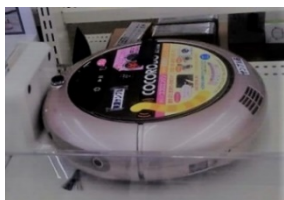
(写真2) 展示会での実演中の床掃除ロボット (部屋の隅々まで移動して床のゴミを吸 い込み、次の作業をするために無人で方 向を転換中。) (筆者撮影)
