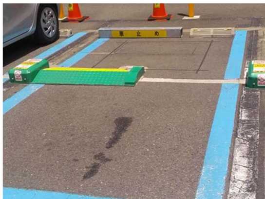
(写真1) よく見かける方式の駐車場の車止め (所定の位置に車が止まると、中央に見える車止め用の黄色の邪魔板が跳ね上がり、車の出入りができないようにする) (執筆者撮影)
