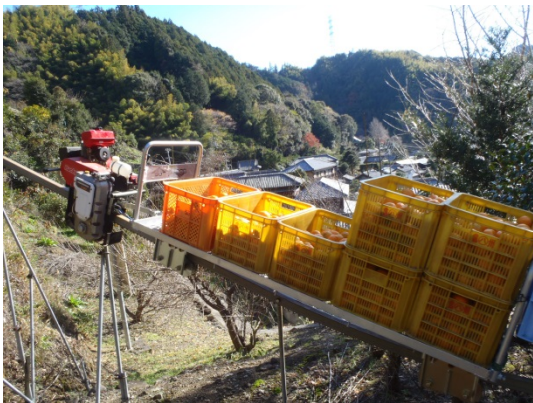
(写真2) みかんを運ぶモノレール (パイプに跨る左のエンジンが、右側の 籠に入っているみかんを牽引している)
