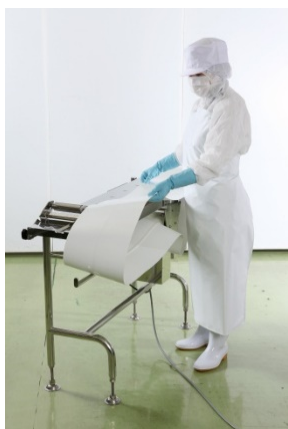
(写真4)作業後には作業員がベルトを外して清掃ができる
