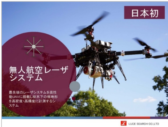
(写真1)活躍するドローンSPIDER-eX (ルーチェサーチ(株)が開発したレーザー スキャナーを搭載した小型無人ヘリ) [資料提供:ルーチェサーチ(株)]
