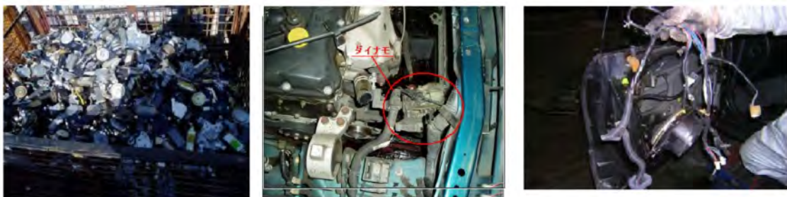
写真-4.1 ドアモーターの取り外し 写真-4.2 ダイナモの取り外し 写真-4.3 ドアハーネスの取り外し
