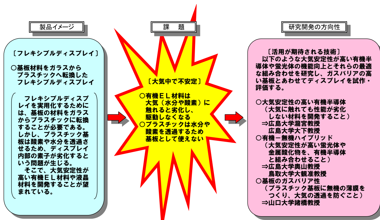
図表IV-4 大気安定性が高いフレキシブルディスプレイに関連する製品イメージ、課題、研究開発の方向性
