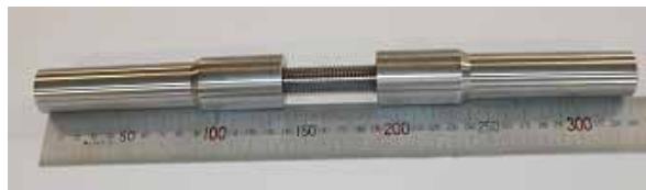
写真：引張試験時の製造ボルト
