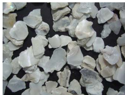
図7. 焼成・粉碎した牡蠣殻の例
